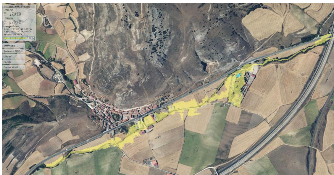
Datos de la línea de inundación para un periodo de retorno T-500 años Fuente (CHEBRO)
